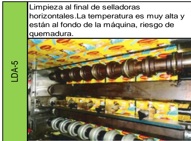
Figura 23. Lugar de difícil acceso a limpieza # 5 de línea 1
