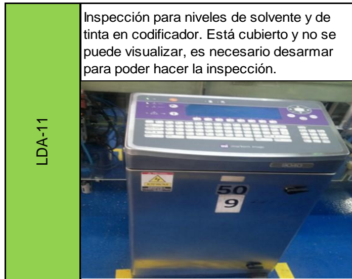
Figura 57. Lugar de difícil acceso a inspección # 4 de línea 2
