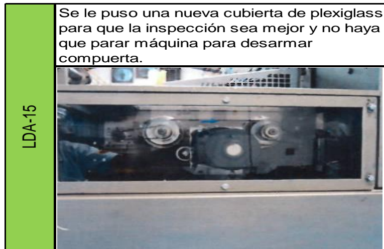
Figura 125. Mejora en lugar de difícil acceso a inspección # 8 de línea 1
