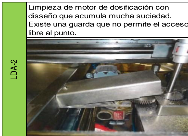
Figura 20. Lugar de difícil acceso a limpieza # 2 de línea 1
