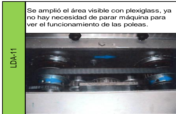
Figura 121. Mejora en lugar de difícil acceso a inspección # 4 de línea 1
