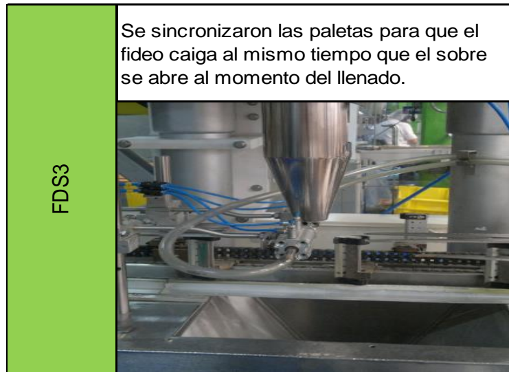
Figura 129. Mejora en fuente de suciedad # 3 de línea 2
