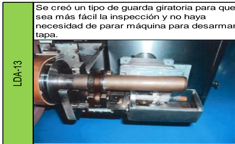
Figura 123. Mejora en lugar de difícil acceso a inspección # 6 de línea 1
