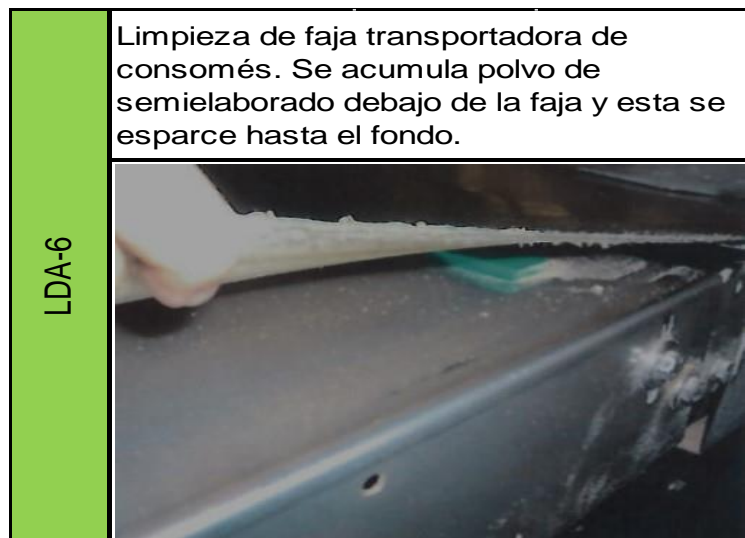
Figura 24. Lugar de difícil acceso a limpieza # 6 de línea 1
