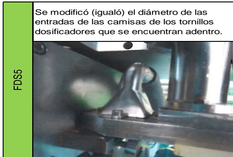
Figura 105. Mejora en fuente de suciedad # 5 de línea 1
