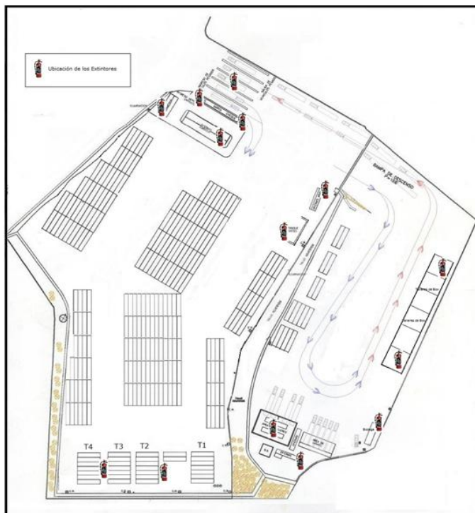
Figura 27. Distribución de extinguidores en la terminal
