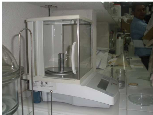
Figura 36. Peso de la celda + cemento + mercurio para ensayo de permeabilidad al aire
