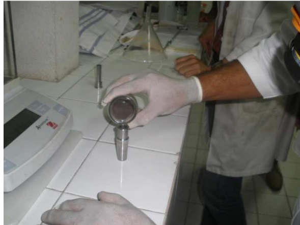
Figura 35. Calibración de celda para ensayo de permeabilidad al aire
