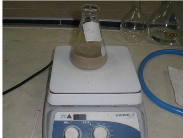
Figura 39. Realización del ensayo fracción soluble en agua
