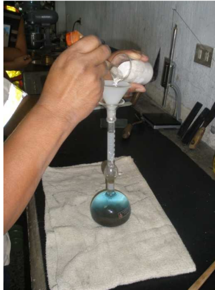
Figura 33. Colocación de la muestra dentro del matraz
