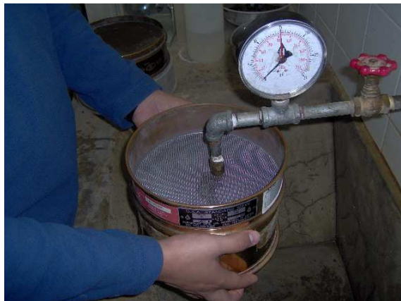
Figura 25. Lavado del Tamiz No. 30 sobre el tamiz No. 200 con una corriente de agua ajustada a 10 psi
