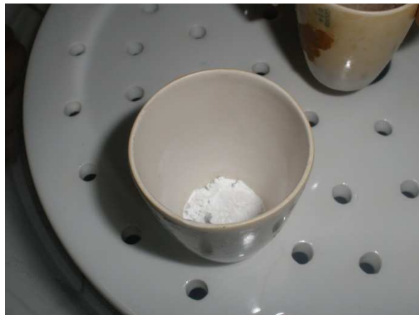
Figura 40. Crisol conteniendo la muestra para realizar el ensayo de pérdida por ignición
