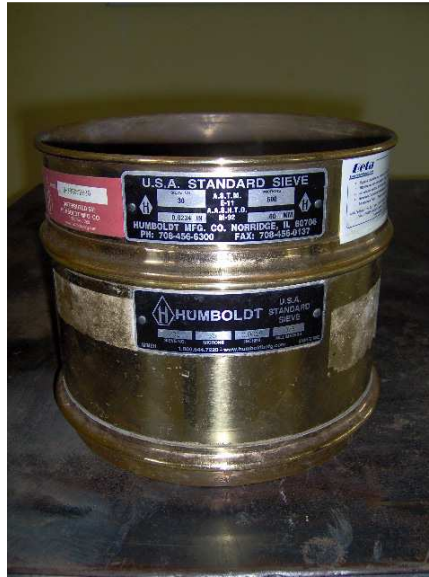
Figura 24. Tamiz No. 30 sobre el tamiz No. 200 siguiendo las indicaciones de la norma ASTM C 110-11
