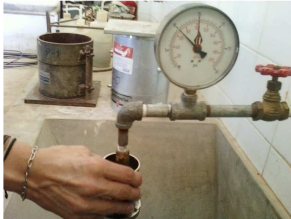
Figura 31. Lavado de la muestra mediante movimientos circulares
