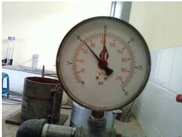
Figura 30. Ajuste de la presión del aspersor de agua a 10 psi
