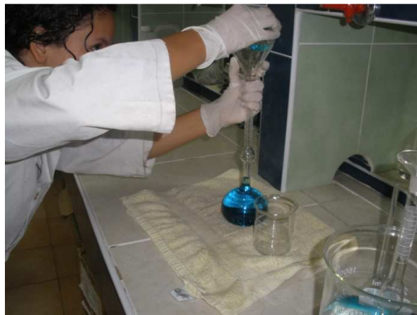
Figura 32. Llenado del matraz con keroseno
