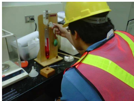
Figura 38. Realización del ensayo de permeabilidad al aire
