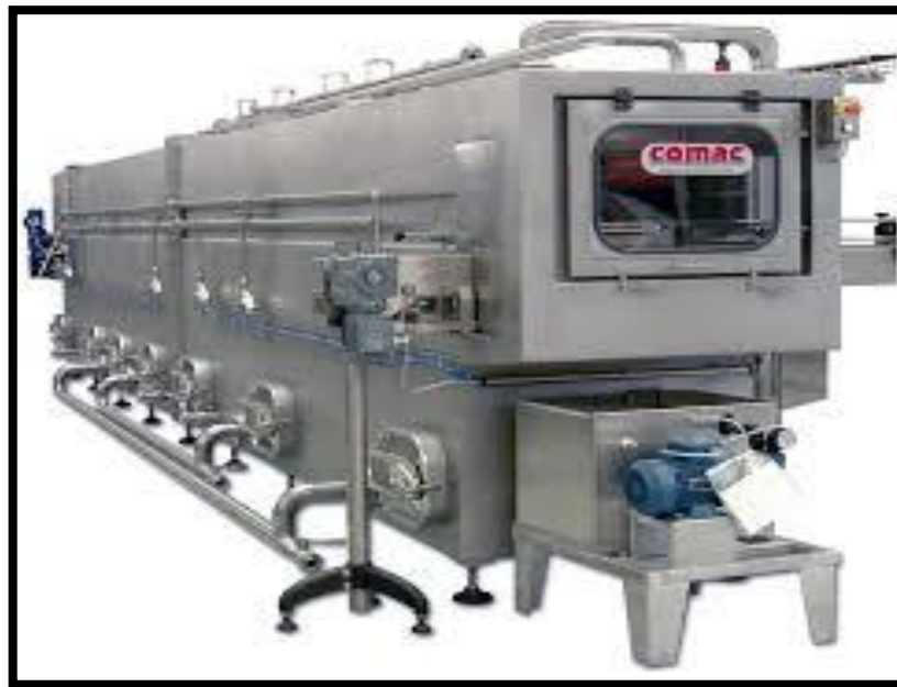
Figura 17. Máquina para el enfriamiento de envase
