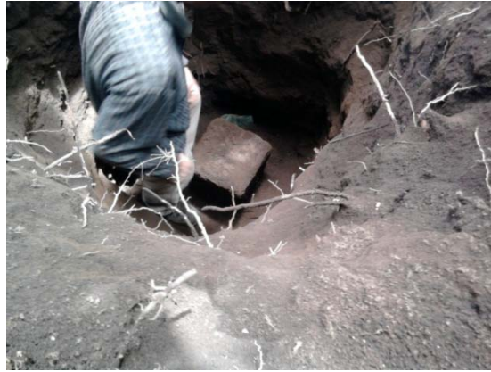
Figura 4. Toma de muestra de 1 pie cúbico
