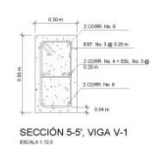
SECCIÓN 5-5', VIGA V-1 ESCALA 1:20
