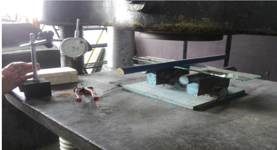
Figura 8. Colocado de la probeta para ensayo a flexión
