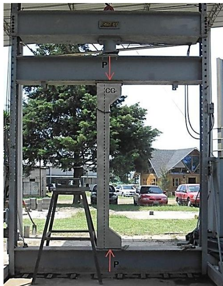
Figura 51. Columna carga excéntricamente
