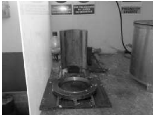
Figura 8. Limpieza de molde de nivelación
