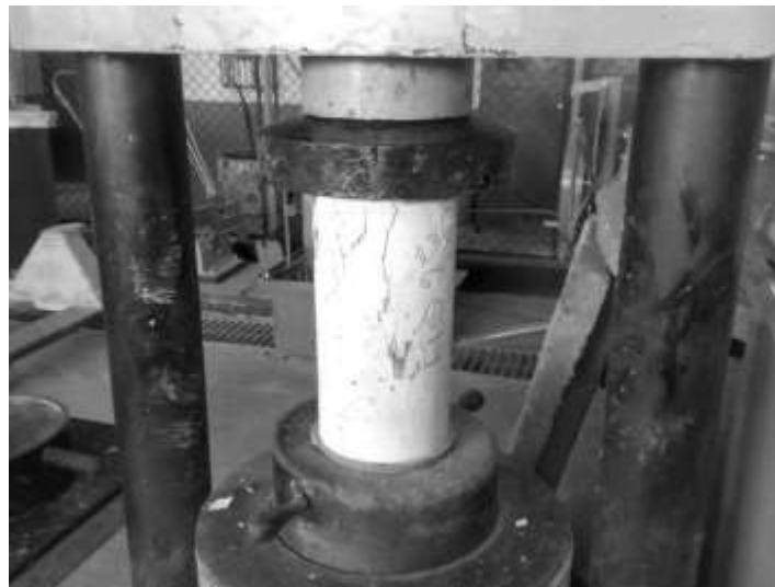
Figura 15. Falla del cilindro de concreto
