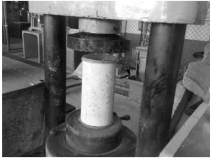
Figura 14. Colocación del cilindro de concreto
