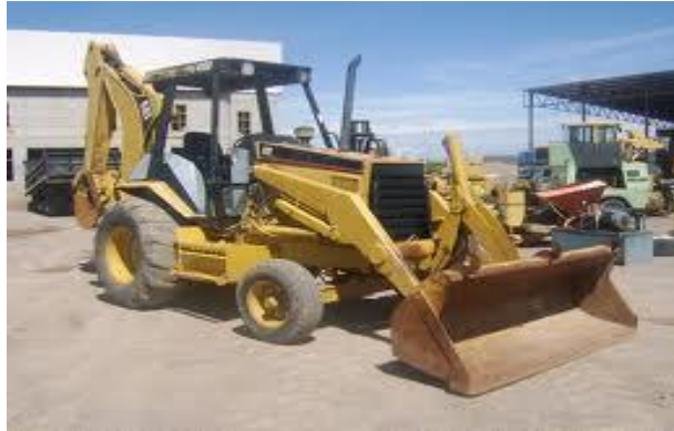
Figura 6. Retroexcavadora de llanta
