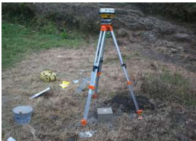
Figura 20. Receptor colocado sobre el vértice
