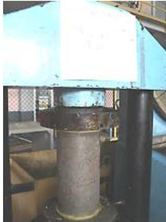
a. Cilindro ensayado a 7 días, concreto convencional.
