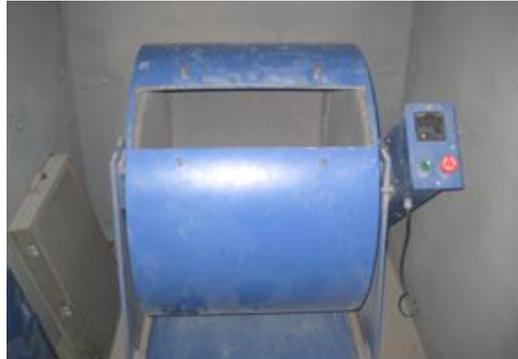
Fuente: máquina de Los Ángeles, para ensayo de abrasión, laboratorio de agregados y concreto CII/USAC.
