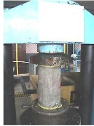
b. Cilindro ensayado a 7 días, concreto reciclado.
