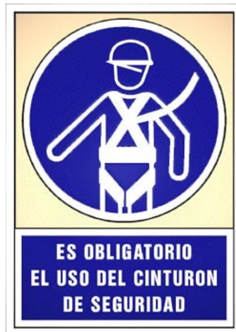
Figura 12. Señalización para trabajos en altura
