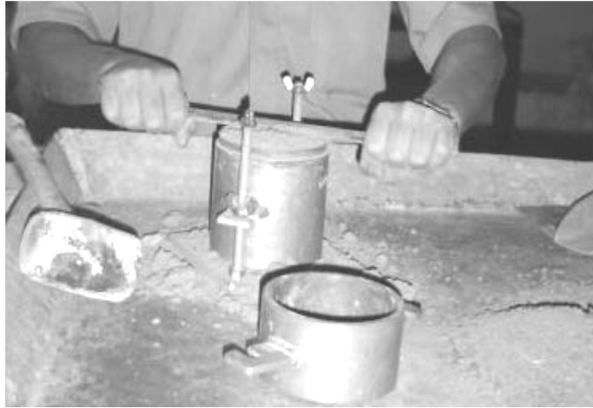
Figura 27. Preparación de muestras en el ensayo de compactación
