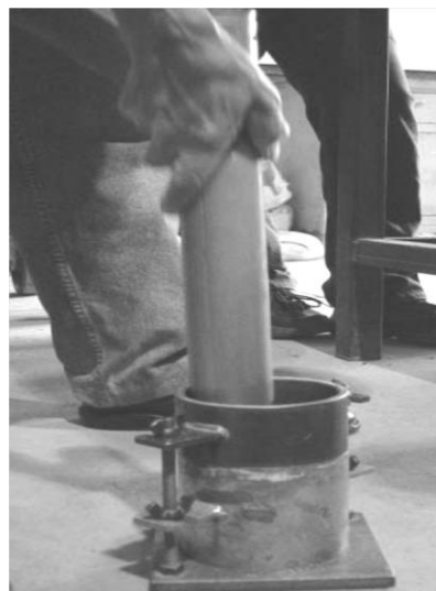
Figura 26. Realización de ensayo de compactación
