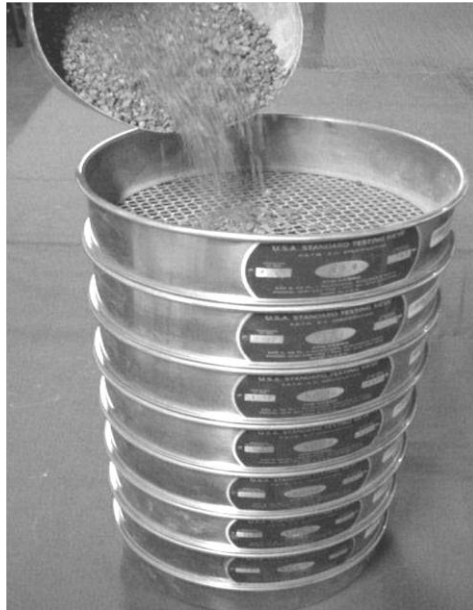
Figura 25. Realización de ensayo de granulometría
