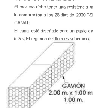
PROYECCIÓN DE TERCERA CAMA DE GAVIONES
