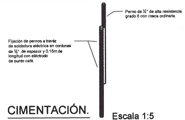
Detalle de perno de anclaje
