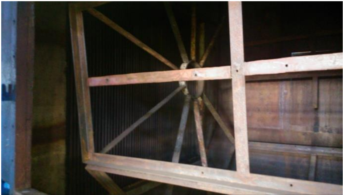
Figura 11. Panales rectangulares con malla de tamiz para filtrar e azúcar
