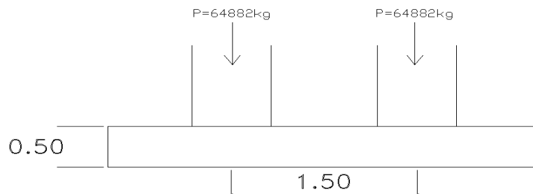
Figura 43. Sección zapata combinada
