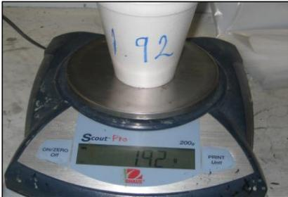
3 Luego colocar un vaso en cada una de las salidas de resina y correctante del cabezal.
