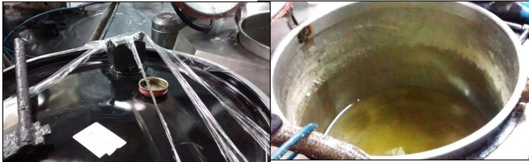
4. Limpiar las paredes de ambas ollas con trapos, espátula de metal y acetato de etilo. Colocar un trapo que funcione como tapón en la salida hacia la manguera de alimentación para impedir que se creen grumos y se tape.
