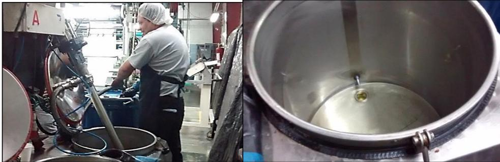
3. Vaciar la olla de resina, por la manguera del cabezal.
