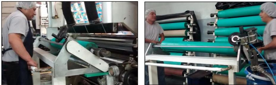
9. Colocar el nuevo rodillo en el carrito y llevarlo a la máquina, luego instalarlo y ajustar la base del eje y las mordazas correctamente. Limpiar con un trapo el polvo y cualquier tipo de suciedad que pueda tener.
