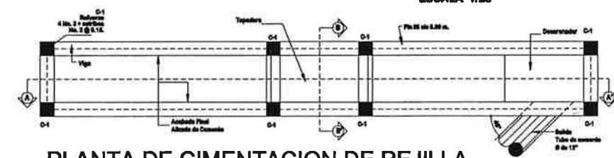
PLANTA DE CIMENTACION DE REJILLA ESCALA 1/25
