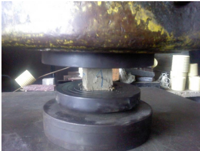
Figura 30. Aplicación de carga a compresión
