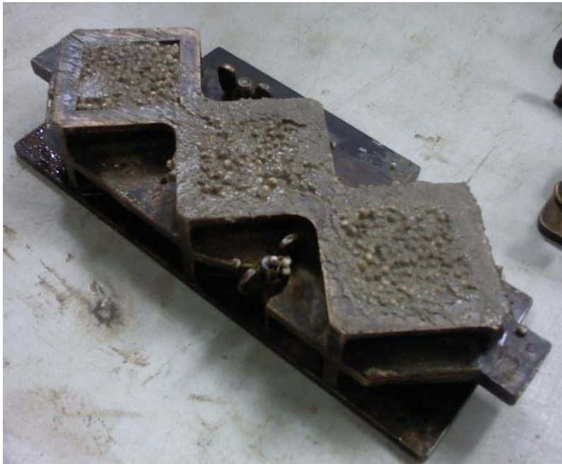
Figura 28. Mezcla vertida en los moldes
