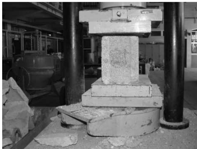
Figura 22. Aplicación de fuerza axial sobre una unidad de mamposte
