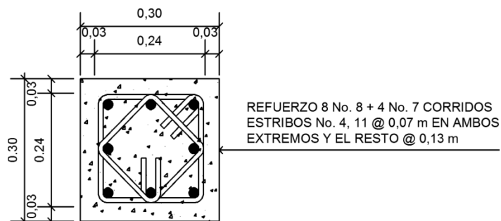
Figura 27. Detalle de columna R-K
