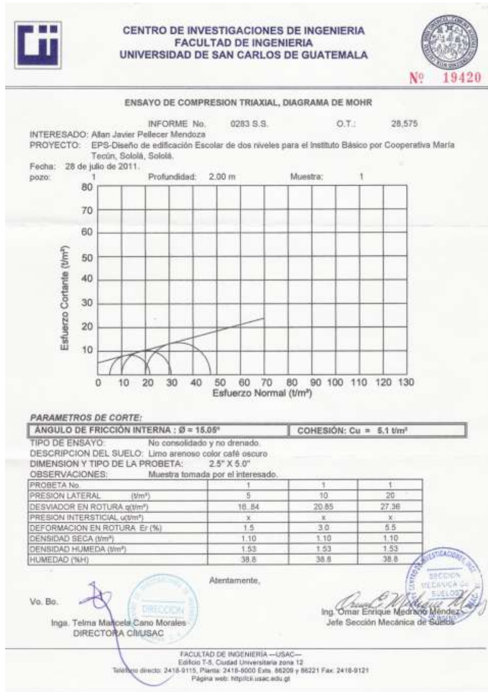
Figura 71. Estudio de suelos, ensayo de compresión triaxial
