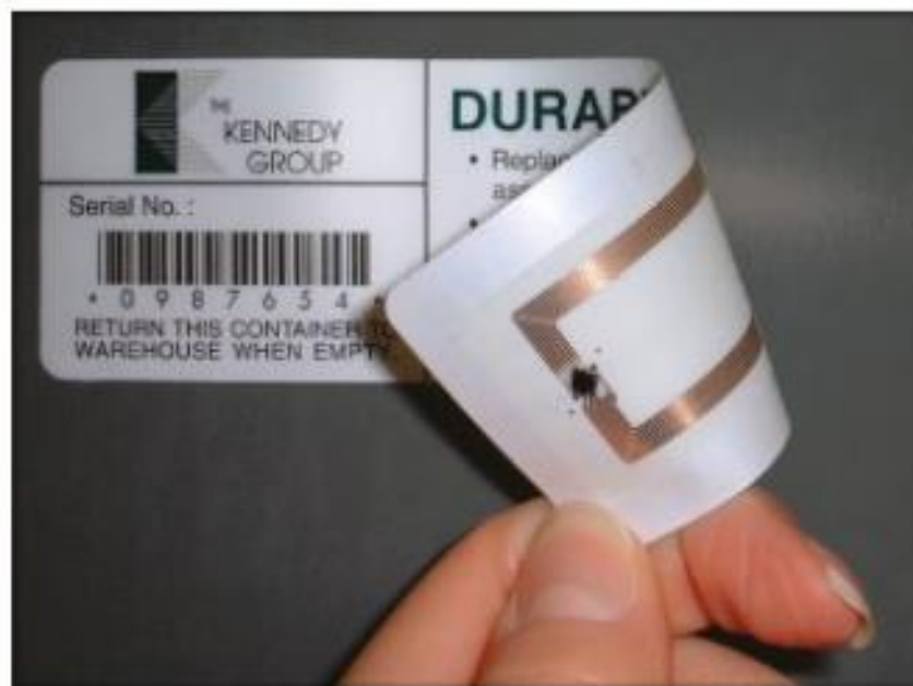
Figura 17. Logística con RFID y tag pasivo
