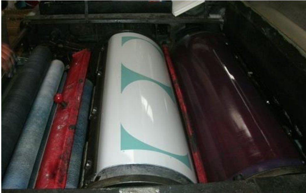
Figura 9. Cilindro de placa y caucho, cilindro de presión no expuesto
