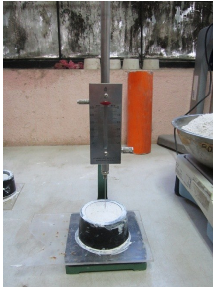
Figura 7. Ensayo de tiempo de fraguado por el método de las agujas de Vicat
