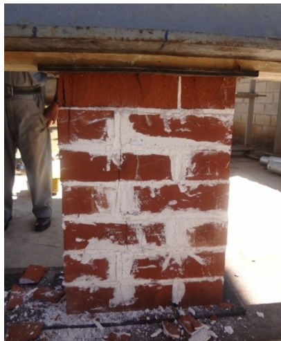
Figura 10. Ensayo de prismas a compresión
