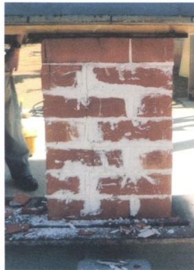
Figura 3: La imagen muestra los prismas ensayados a esfuerzos de compresión.
