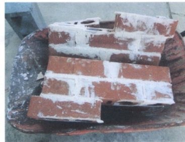
Figura 7: La imagen muestra los prismas ensayados fricción y adherencia.
