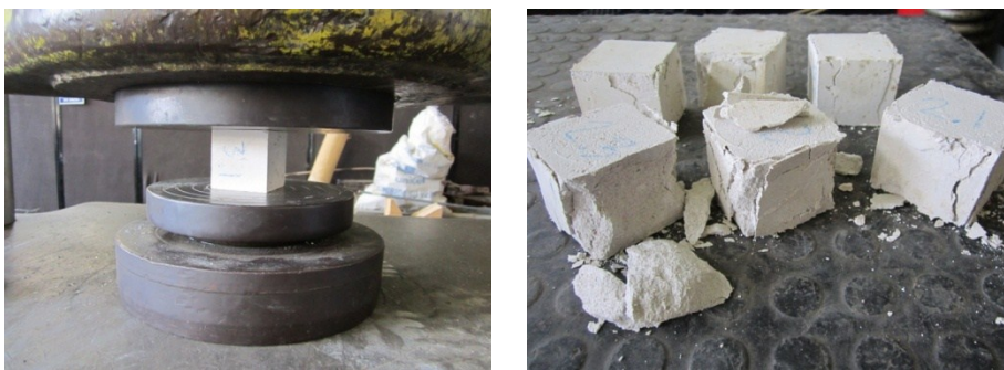
Figura 8. Ensayo de compresión del mortero
