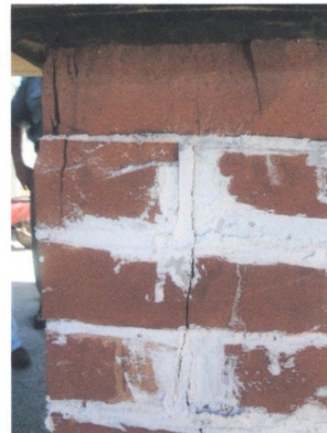
Figura 3: La imagen muestra los prismas ensayados a esfuerzos de compresión.
