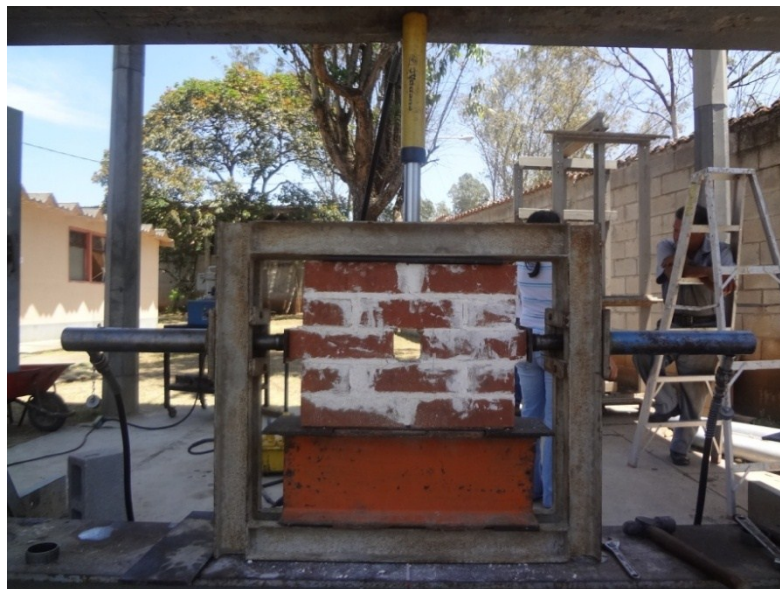
Figura 12. Ensayo de prismas a fricción y adherencia
