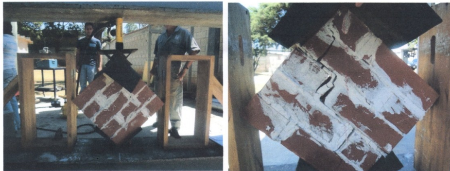
Figura 5: La imagen muestra los prismas ensayados a esfuerzos cortantes.
