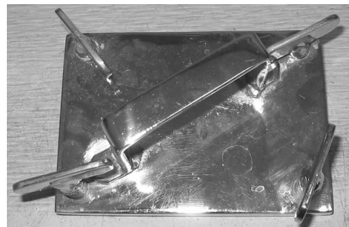
Figura 13. Herramienta de acero para colocación y ensayo de probetas
