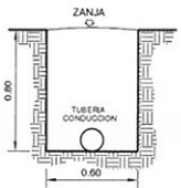
DETALLE TIPICO DE ZANJA TRAMO CON UNA TUBERIA DE CONDUCCION ESCALA 1/25
