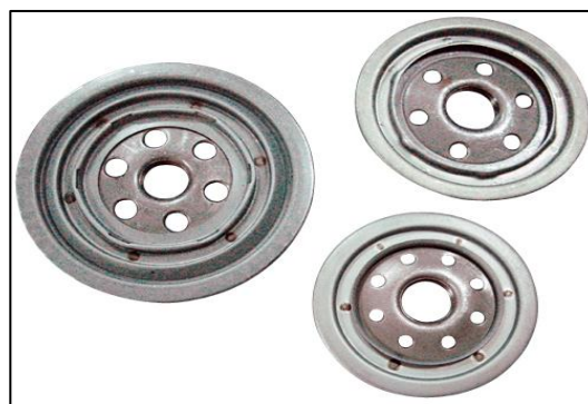
Figura 26. Filtros de Aceite soldados con máquinas Dahching
