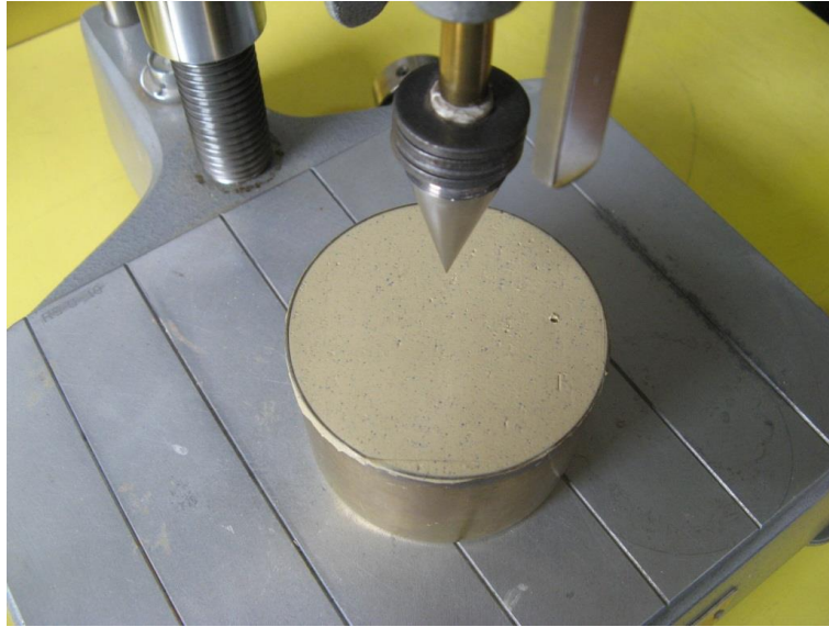
Figura 15. Centrado de muestra en el penetrómetro
