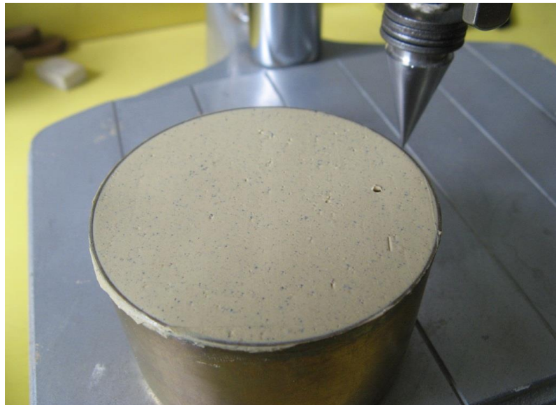
Figura 14. Muestra rasada en el tarro de ensayo
