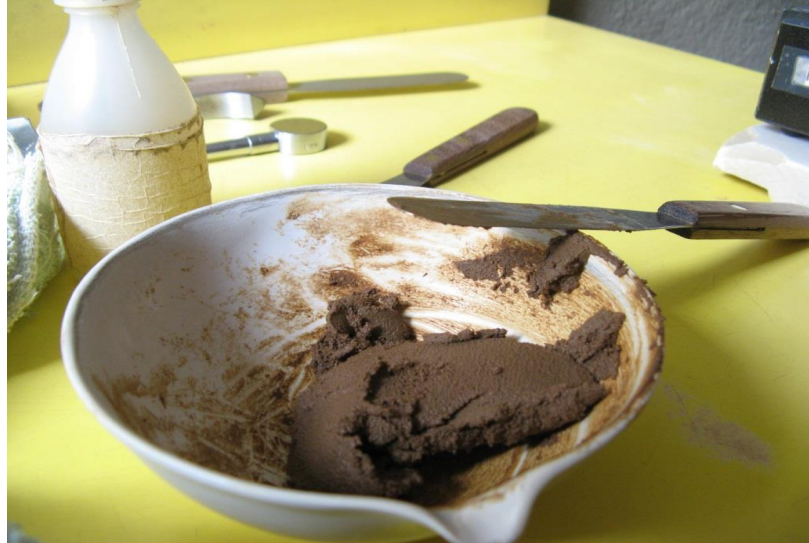
Figura 4. Mezclado de muestra para límite líquido
