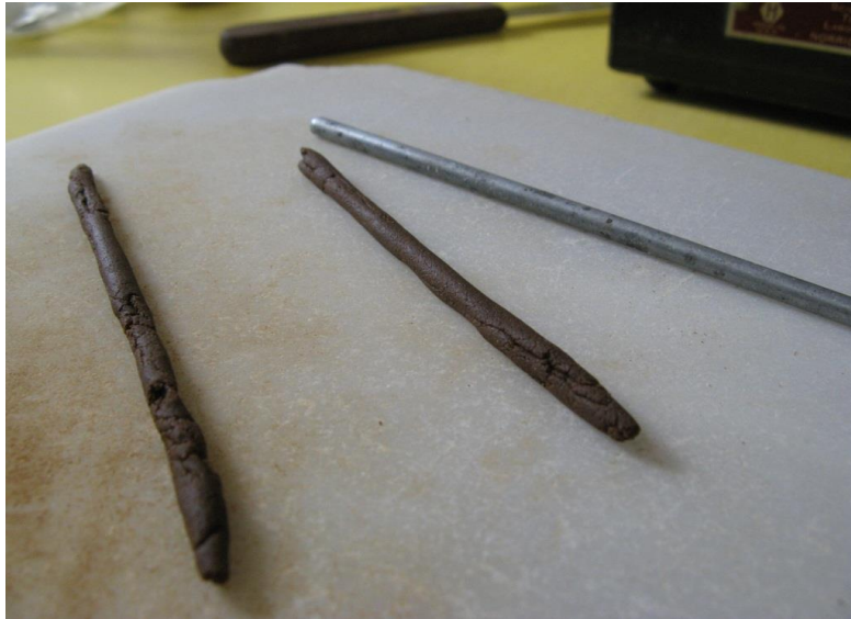
Figura 9. Moldeado de cilindros con alambre de referencia de 1/8"
