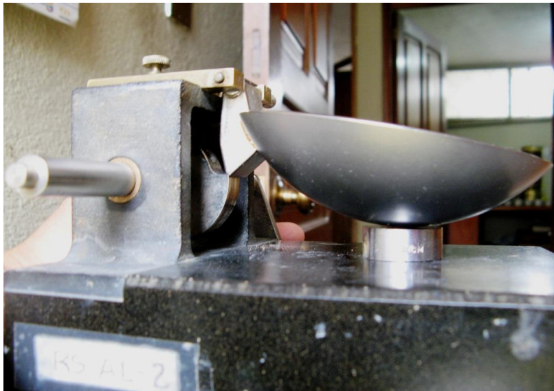
Figura 3. Detalle de talón del aparato de Casagrande al ser calibrado
