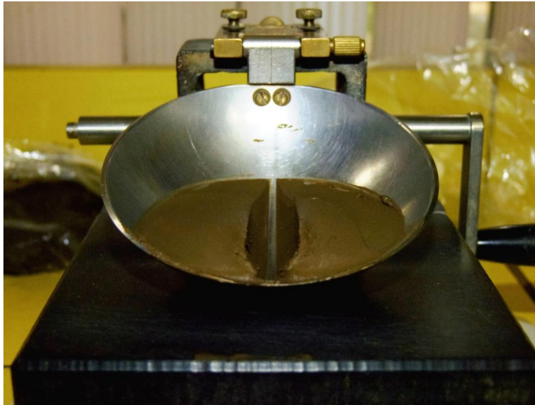
Figura 6. Ranurado para ensayo de límite líquido
