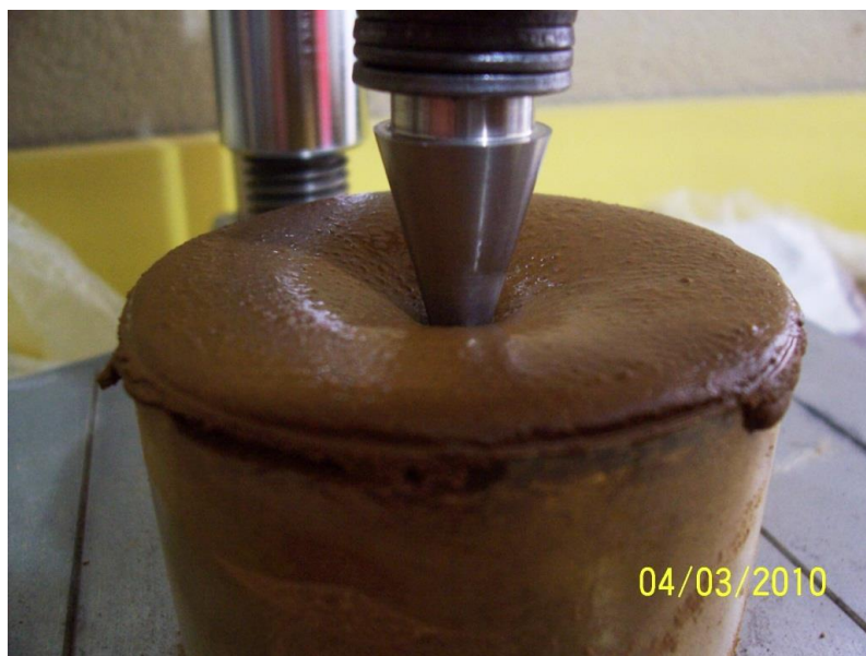
Figura 19. Ensayo de penetrómetro luego de caída libre de 5 segundos en muestra limosa
