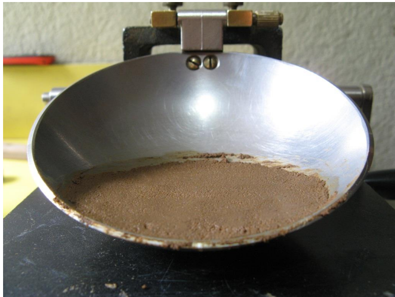
Figura 5. Nivelado de muestra en el aparato de Casagrande
