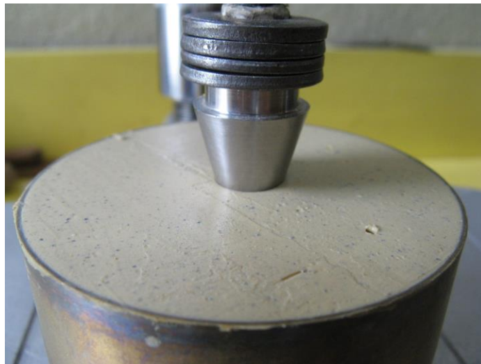
Figura 18. Ensayo de penetrómetro luego de caída libre de 5 segundos en muestra arcillosa
