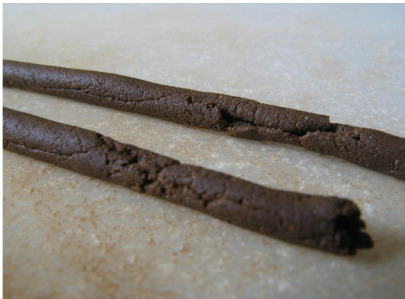
Figura 10. Detalle de cilindros agrietados al límite plástico
