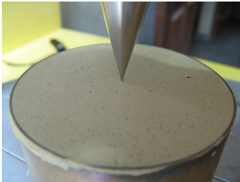
Figura 16. Penetrómetro al ras de la muestra
