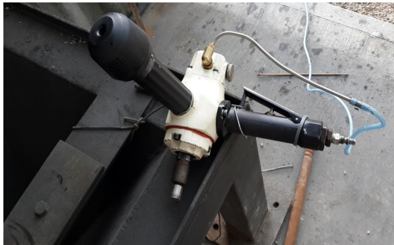
Figura 29. Afiladora de brocas con copas de afilado intercambiables
