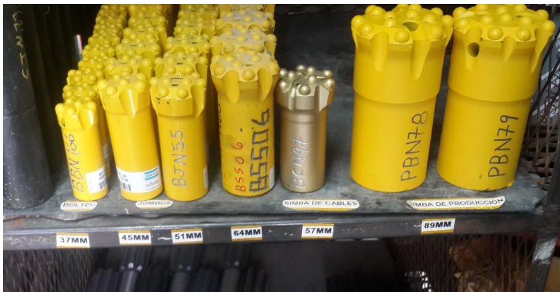
Figura 6. Brocas utilizadas para la perforación de área de mina subterránea
