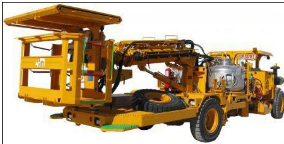
Figura 8. Maquinaria utilizada para carga de explosivos
