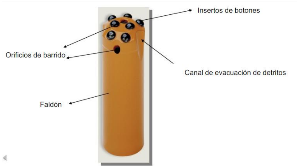
Figura 23. Brocas utilizadas en mina subterránea
