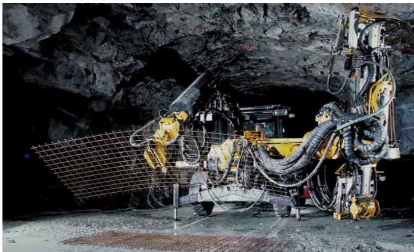
Figura 14. Maquinaria utilizada para sostenimiento (boltec)
