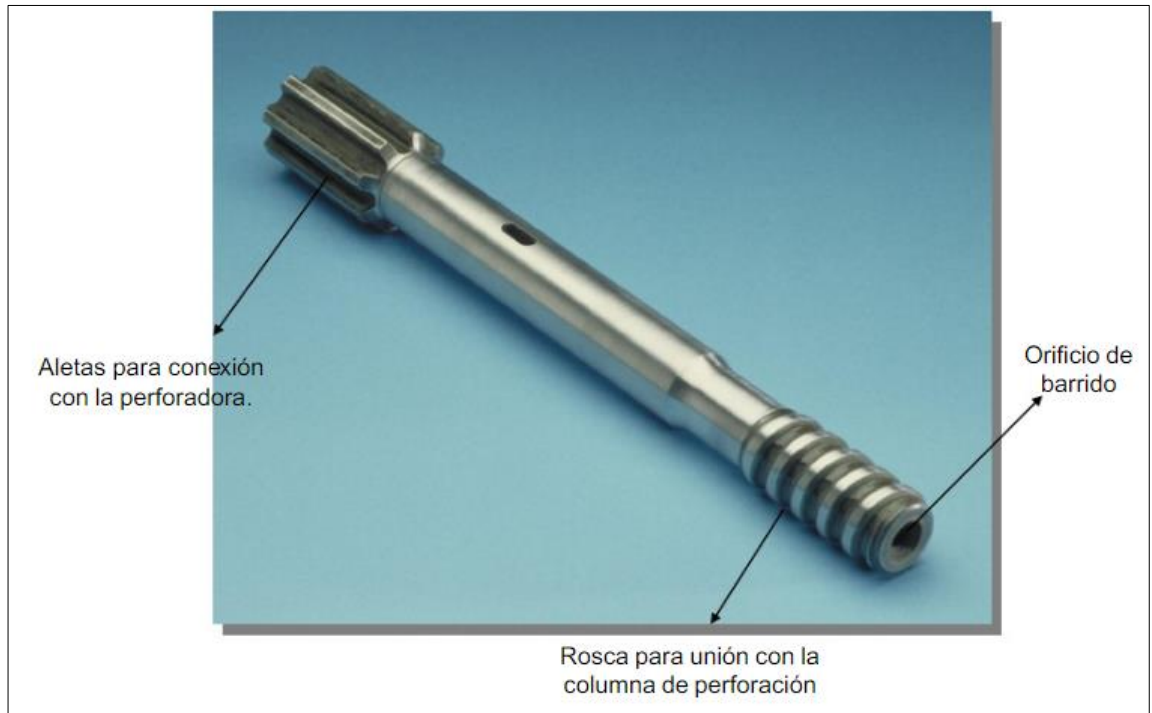
Figura 20. Acople utilizado en mina subterránea para jumbo
