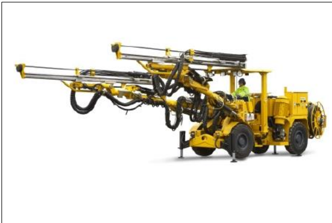
Figura 5. Maquinaria utilizada para perforación (jumbo)
