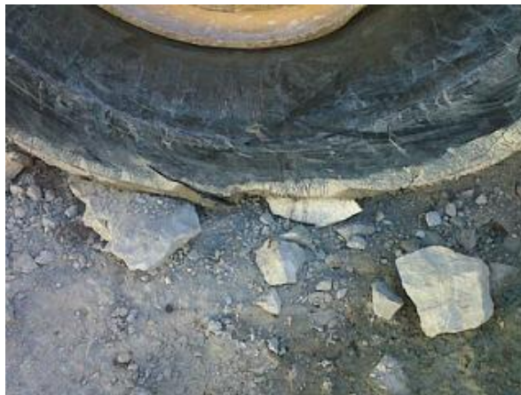
Figura 10. Neumático de scooptram cortado por una roca
