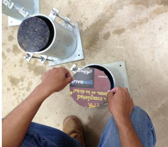
Figura 42. Preparación de probetas para correr el CBR
