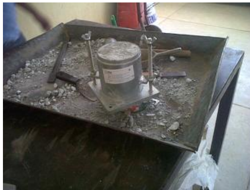
Figura 41. Preparación de material para ensayo CBR 10 golpes
