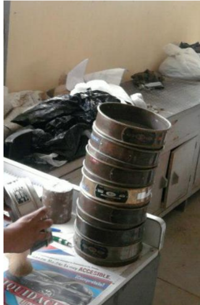
Figura 45. Colocación de material en tamices
