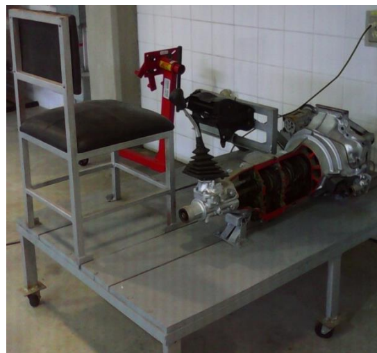
Figura 14. Modelo didáctico de transmisión mecánica
