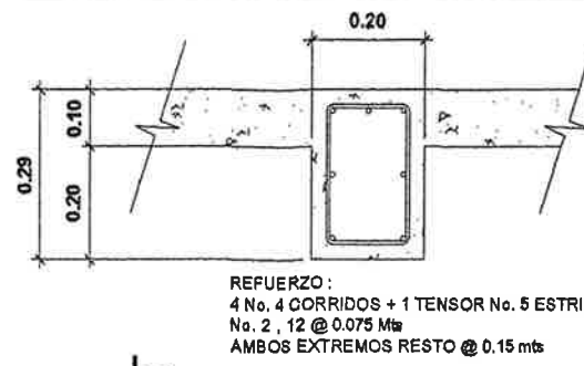
SECCIÓN A-A' DE VIGAS ESCALA: 1/10
