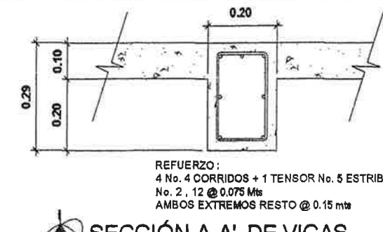
SECCIÓN A-A' DE VIGAS ESCALA: 1/10
