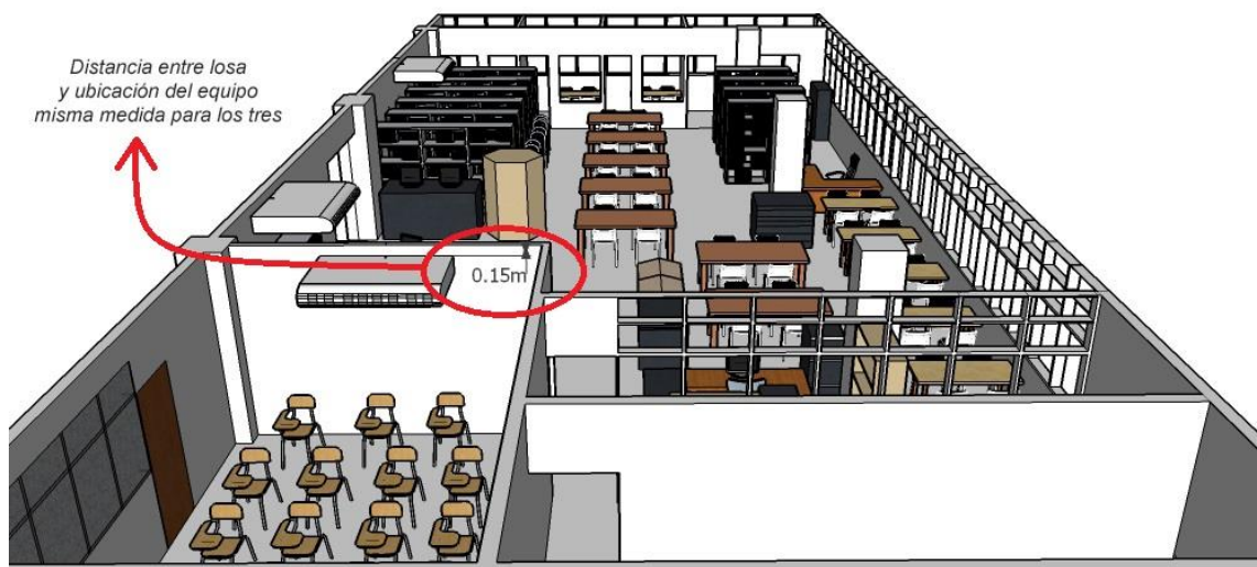
Figura 20. Ubicación del equipo de aire acondicionado de la Biblioteca de la Facultad de Odontología
