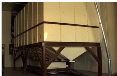
Figura 18. Almacenamiento de café en silos
