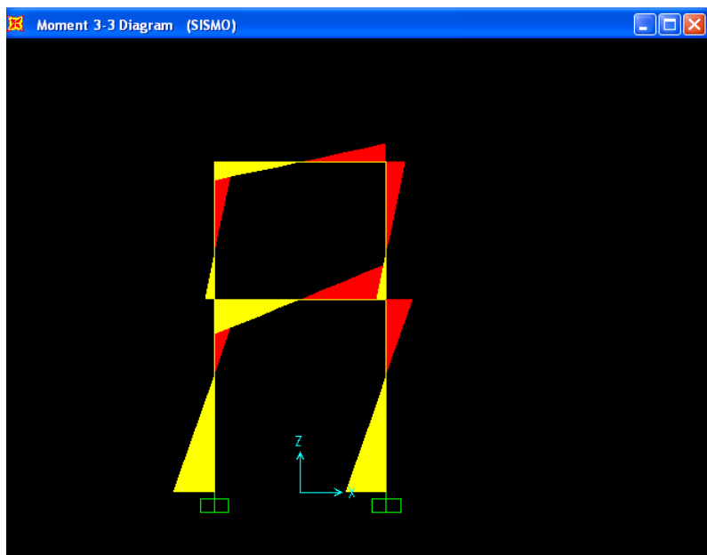
Figura 17. Diagrama de momentos por análisis de carga sísmica con software SAP2000, marco del eje 1, módulo 1
