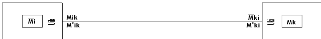
Figura 13. Posición de los momentos por influencia del giro de los nudos del marco según el método de Kani
