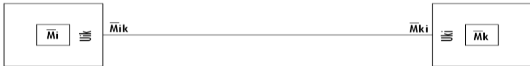
Figura 12. Posición de los factores de giro en los nudos del marco según el método de Kani
