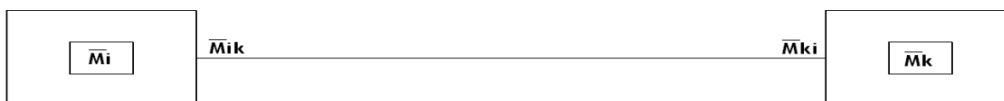
Figura 11. Posición de momentos de sujeción en los nudos del marco según el método de Kani
