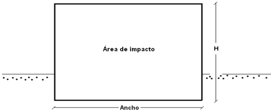
Figura 32. Disipador de energía cara frontal
