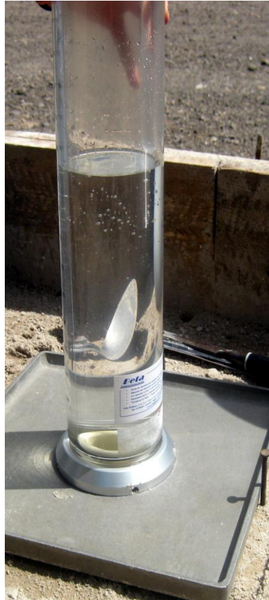
Figura 44. Lectura final aplicando presión
