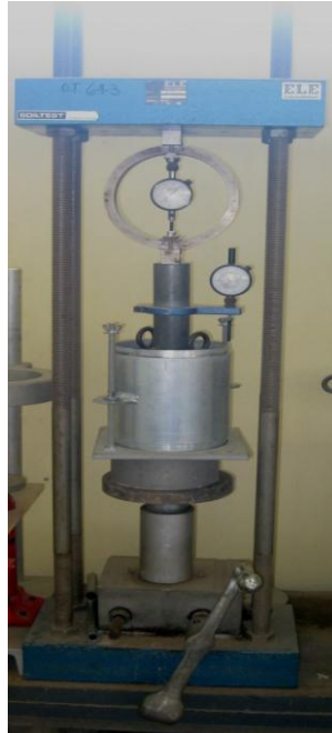
Figura 24. Molde adaptado en máquina de compresión
