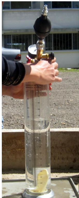
Figura 39. Lectura inicial aplicando presión
