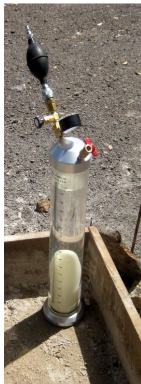
Figura 43. Aparato fuera de base para excavación de agujero
