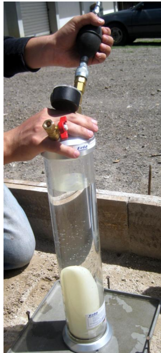
Figura 41. Lectura inicial aplicando succión
