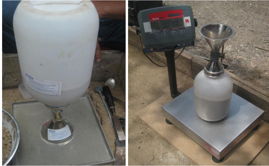
Figura 35. Medición de los picnómetros
