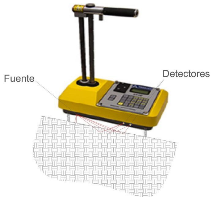
Figura 12. Medición por método del colchón de aire
