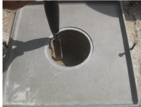
Figura 42. Excavación agujero, método del globo de hule
