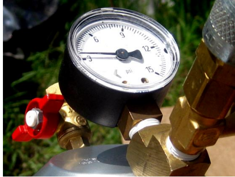
Figura 40. Manómetro en 3 psi para lectura inicial
