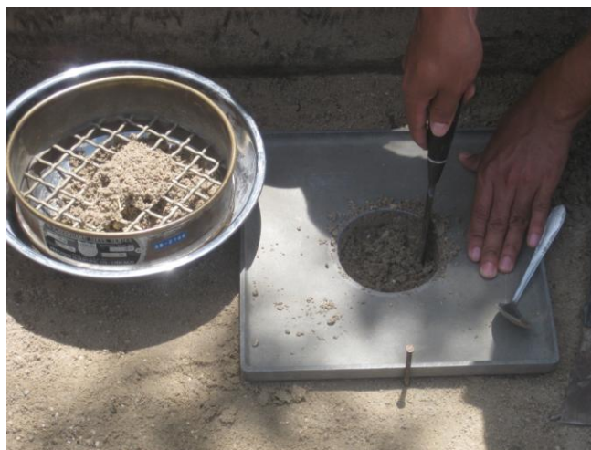
Figura 34. Excavación de agujero, método del cono de arena
