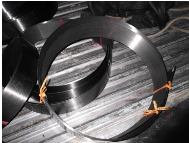
Figura 33. Refuerzo CFRP tipo platina para flección
