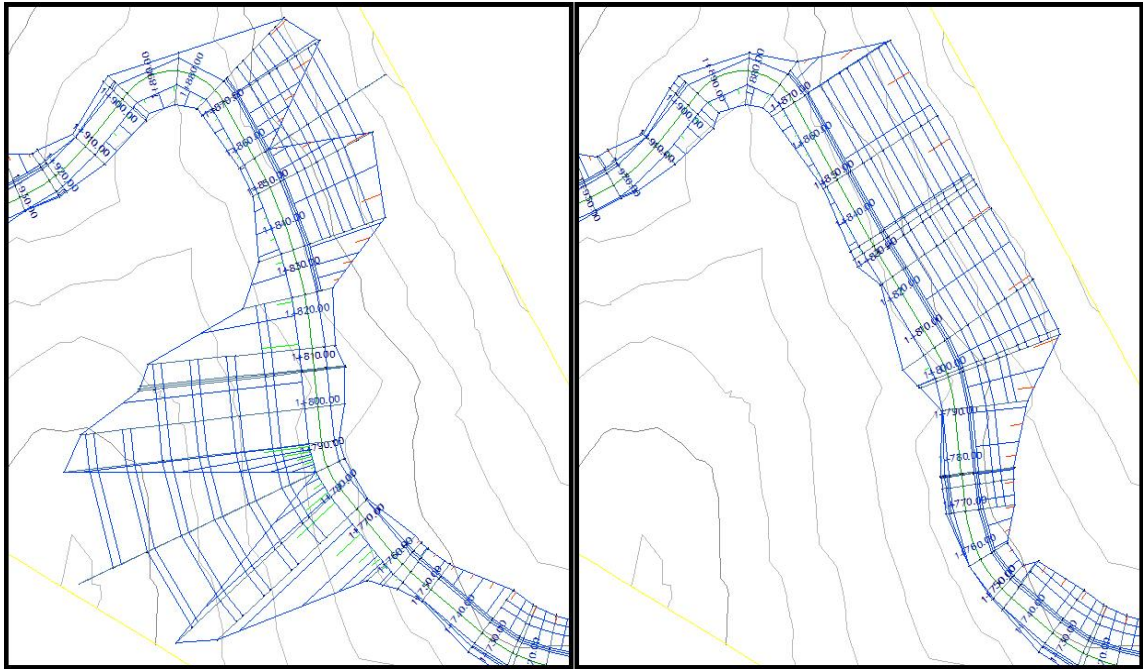
Figura 128. Corregir corridor a partir del alineamiento horizontal
