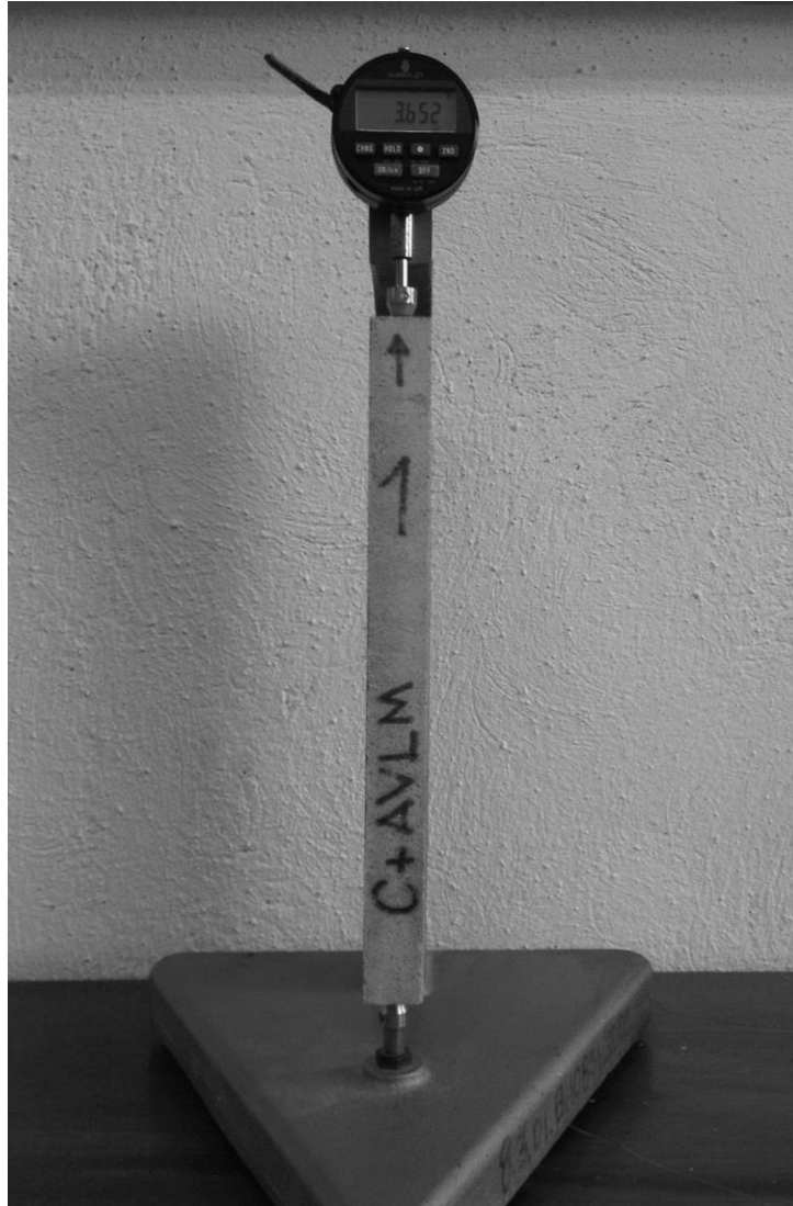
Figura 41. Ensayo de expansión o contracción de barra de mortero
