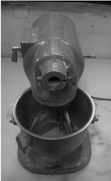
c. Colocación de cemento y agua en la batidora
