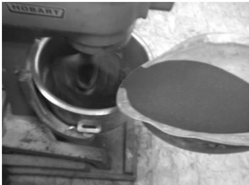
c. Colocación del agregado fino en la mezcladora de mortero.
