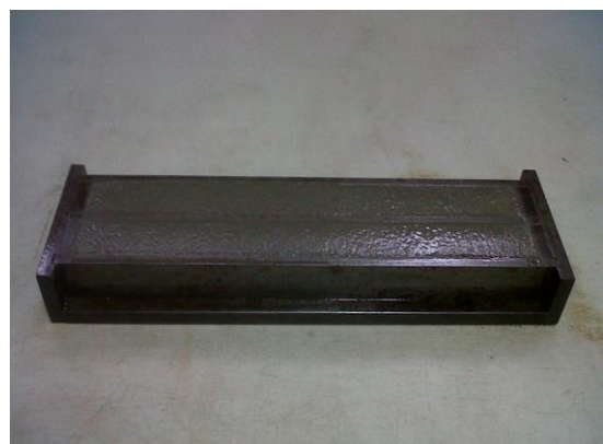
h. Barras de mortero terminadas
