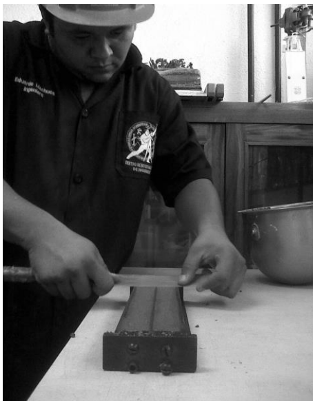
g. Razado del mortero de los moldes de barras para expansión
