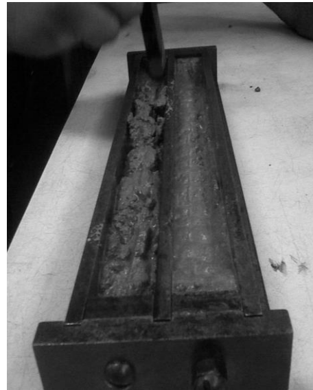
f. Apisonado de mortero en los moldes de barras para expansión
