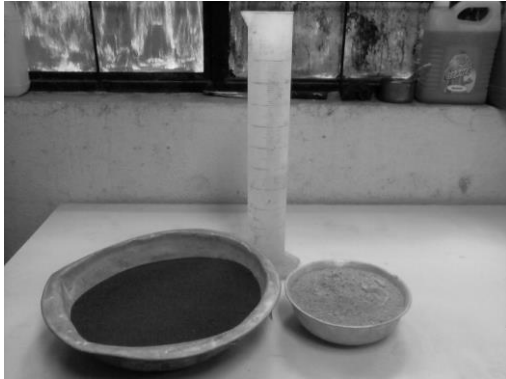
a. Materiales para elaborar cubos de mortero.
