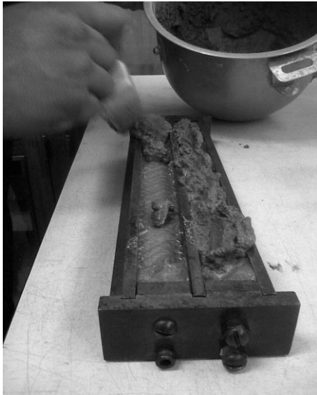
e. Colocación de mortero en los moldes de barras para expansión
