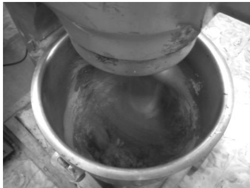
d. Mezclado de materiales en la mezcladora de mortero.
