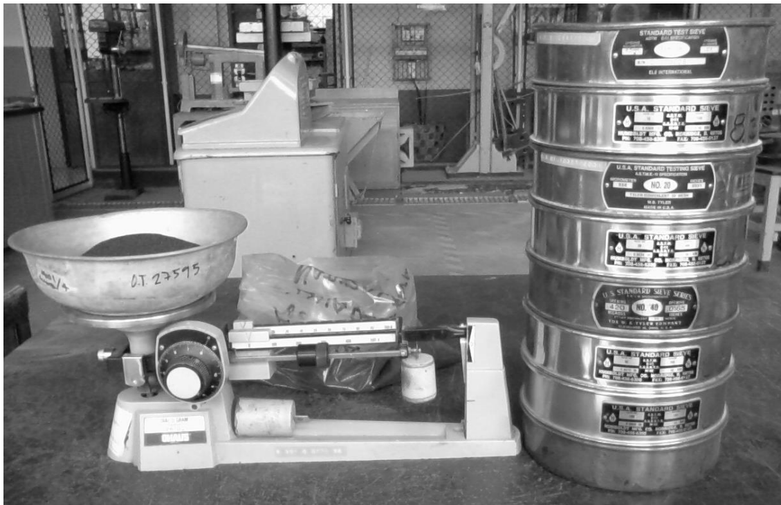
Figura 32. Tamizaje de arena volcánica
