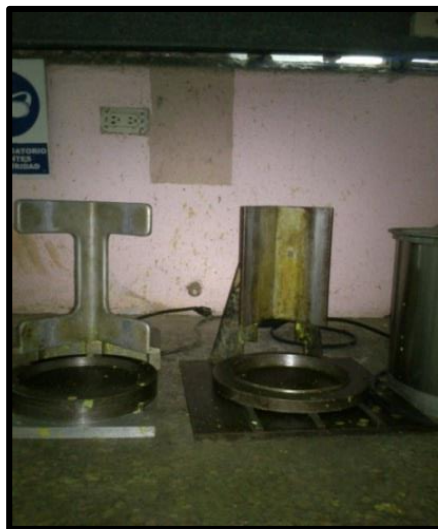
Figura 6. Sistema vertical para cabeceo con azufre
