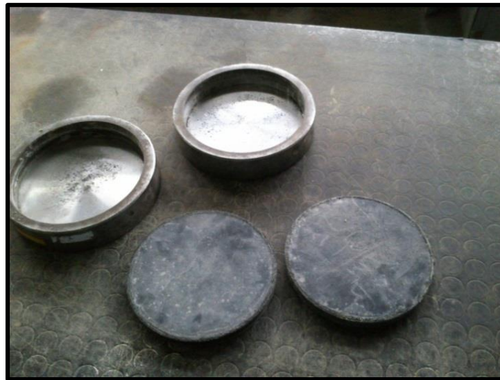
Figura 11. Bases cabeceadoras no adheridas de neopreno
