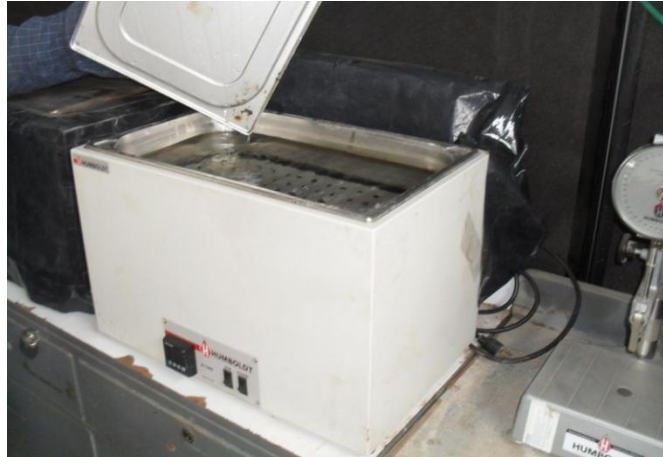
Figura 10. Equipo para mantener condiciones de alta temperatura
