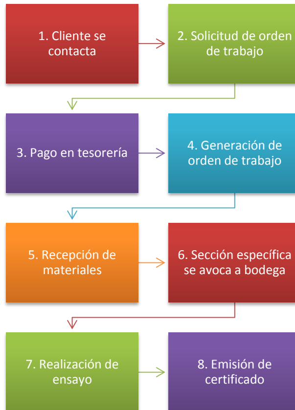
Figura 3. Diagrama actual del procedimiento para la realización de ensayos en la Sección de Mecánica de Suelos del CII
