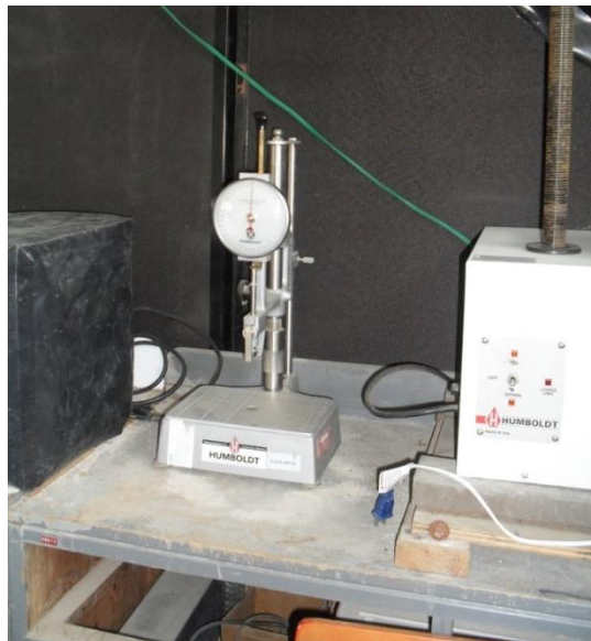
Figura 9. Penetrómetro para analizar la mezcla asfáltica
