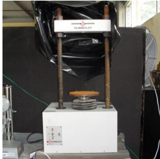
Figura 8. Equipo para ensayo destructivo a probetas de mezcla asfáltica
