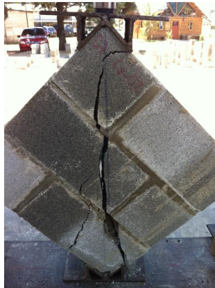
Figura 77. Falla por tensión diagonal
