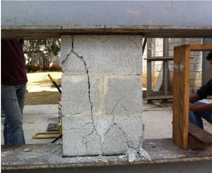
Figura 66. Falla en prisma de mampostería
