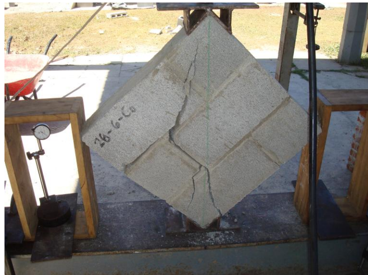
Figura 85. Falla por corte en juntas (posibilidad 2)
