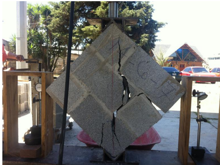
Figura 79. Falla por corte en juntas (posibilidad 2)
