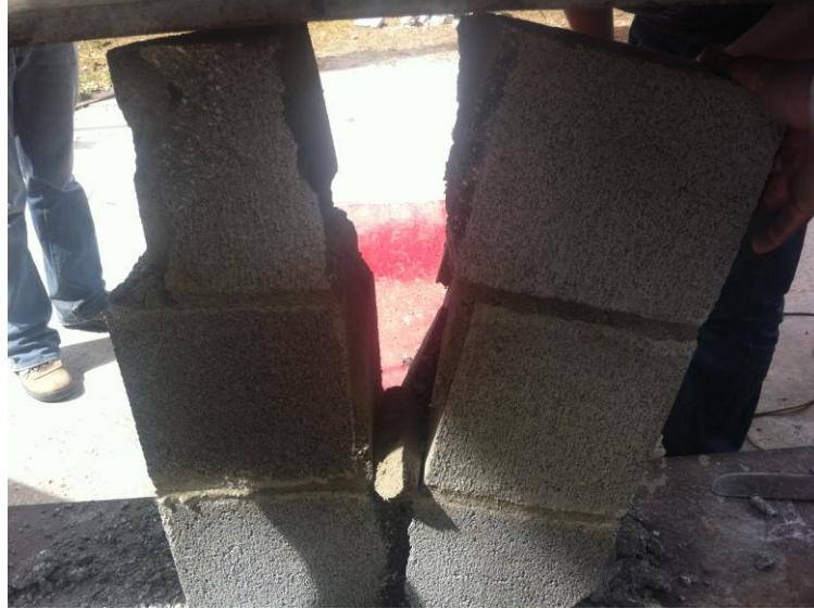
Figura 70. Falla longitudinal de los prismas
