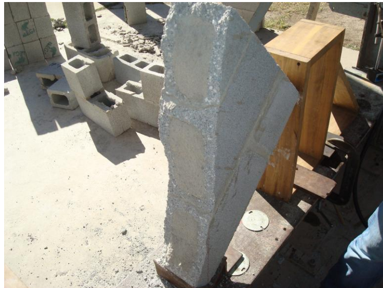
Figura 81. Estado del grout dentro de los prismas de corte llenos
