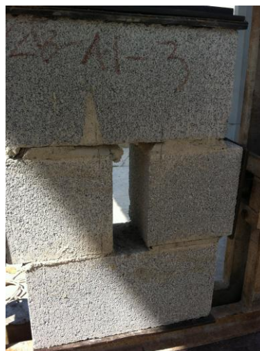
Figura 87. Falla en prisma de adherencia
