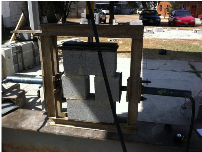
Figura 86. Ensayo de prisma de adherencia
