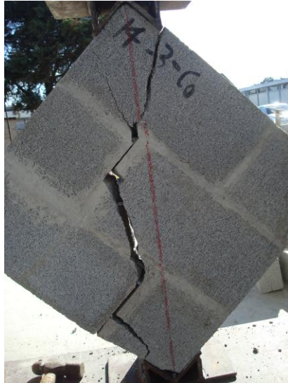
Figura 82. Falla por corte en juntas (posibilidad 1)
