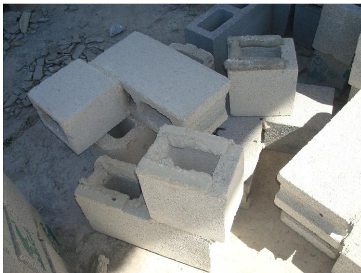
Figura 91. Prismas de adherencia huecos fallados en 3 caras
