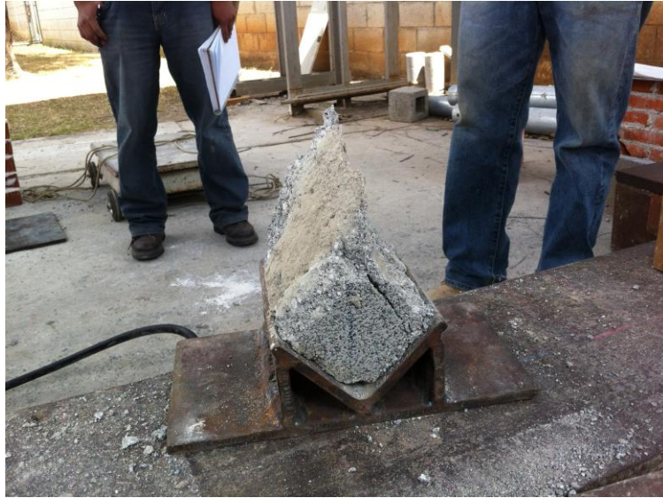
Figura 76. Aplastamiento del prisma de corte
