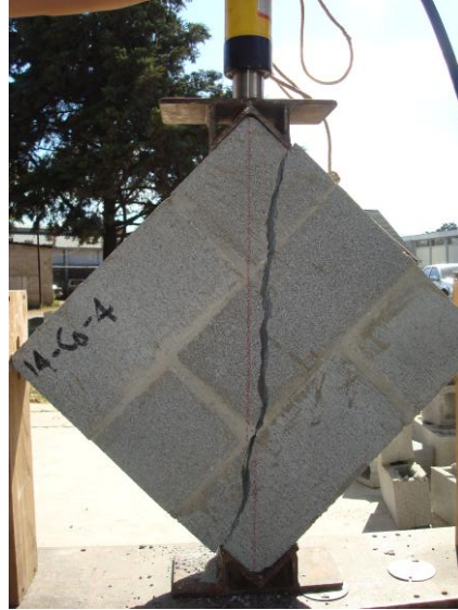
Figura 80. Falla por tensión diagonal
