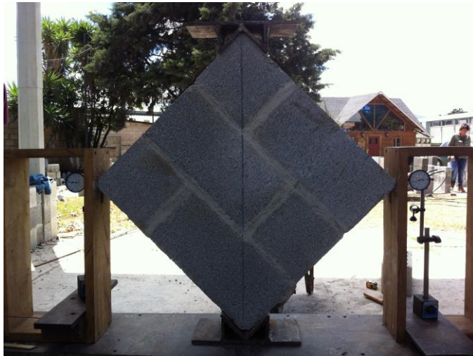
Figura 74. Ensayo de prisma a corte
