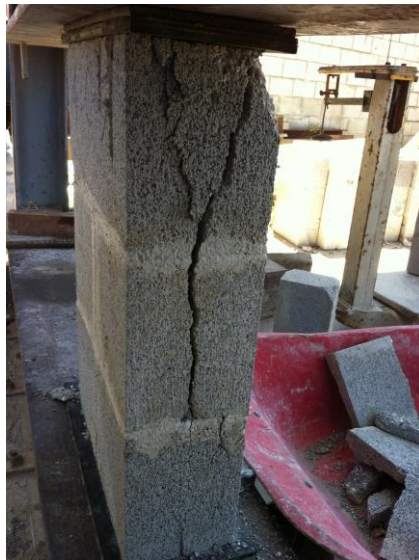
Figura 71. Falla lateral en prismas de compresión
