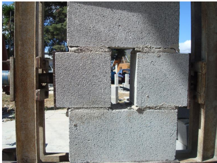
Figura 89. Falla en prismas de adherencia
