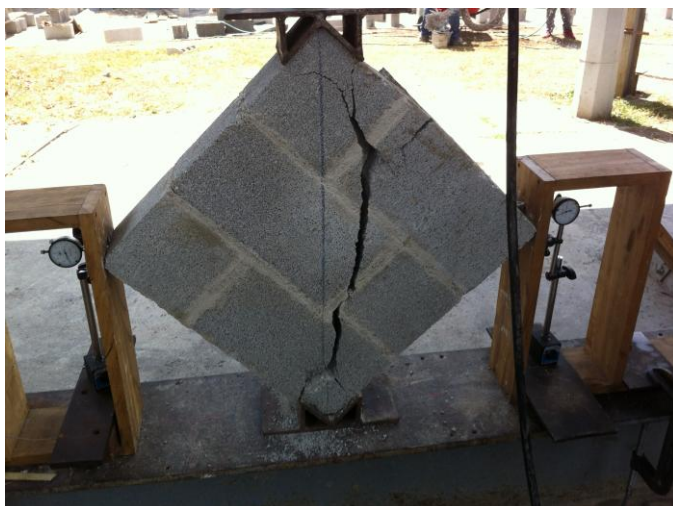
Figura 75. Falla por tensión diagonal
