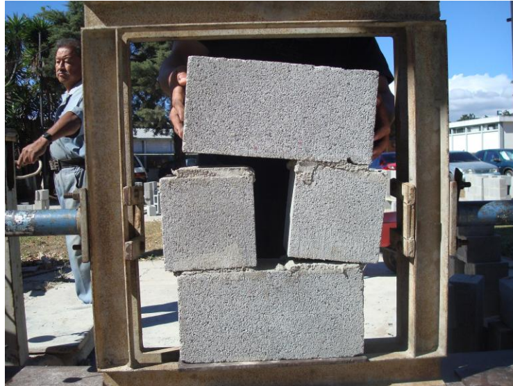
Figura 88. Falla de dos caras en prismas de adherencia
