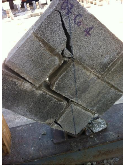
Figura 78. Falla por corte en las juntas (posibilidad 1)
