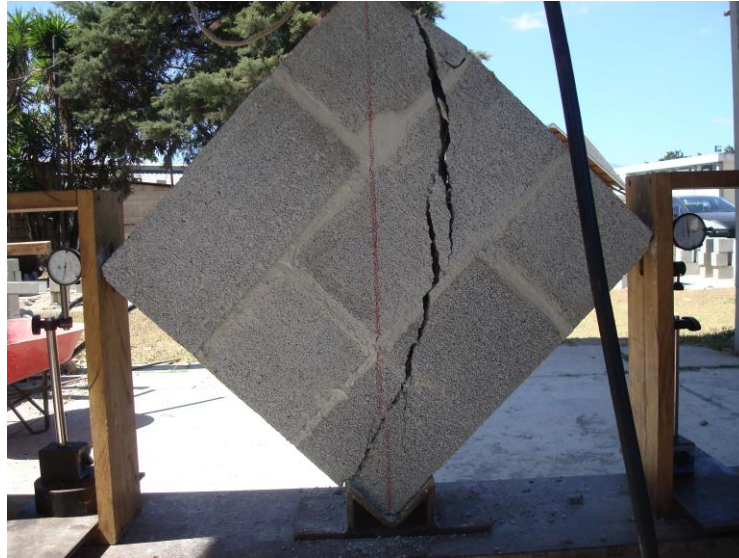
Figura 84. Falla por tensión diagonal
