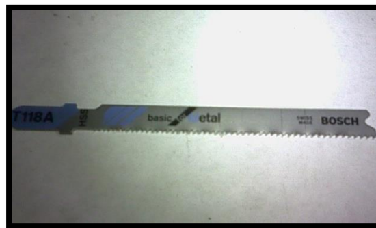
Figura 52. Sierra para caladora para metal
