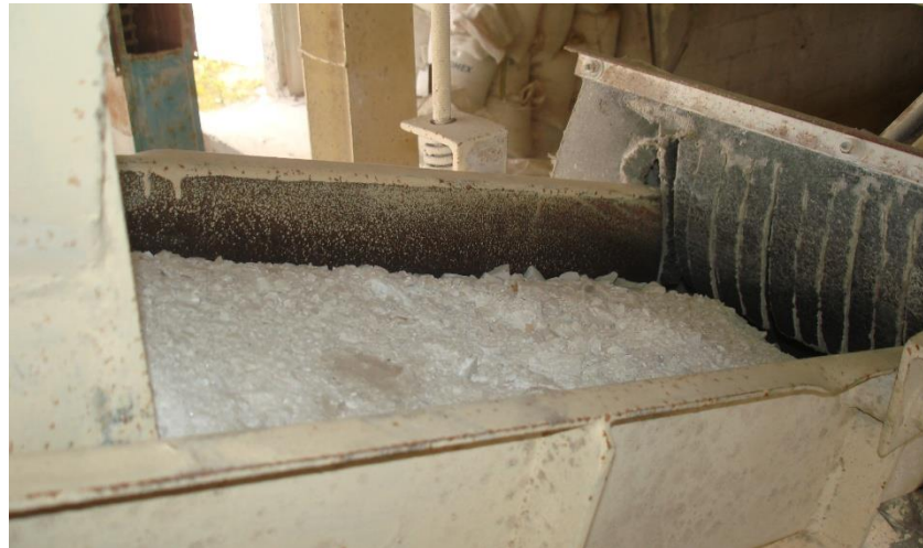
Figura 69. Fragmentos de retal generados en la trituración secundaria
