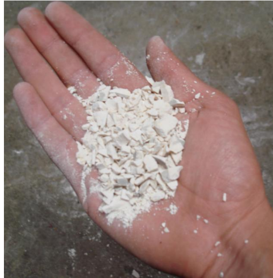
Figura 71. Fragmentos de retal generados en la trituración terciaria
