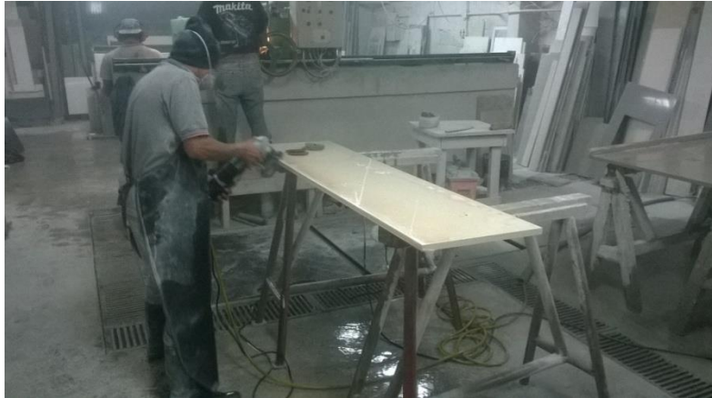
Figura 30. Pulido y brillo de las piezas de mármol
