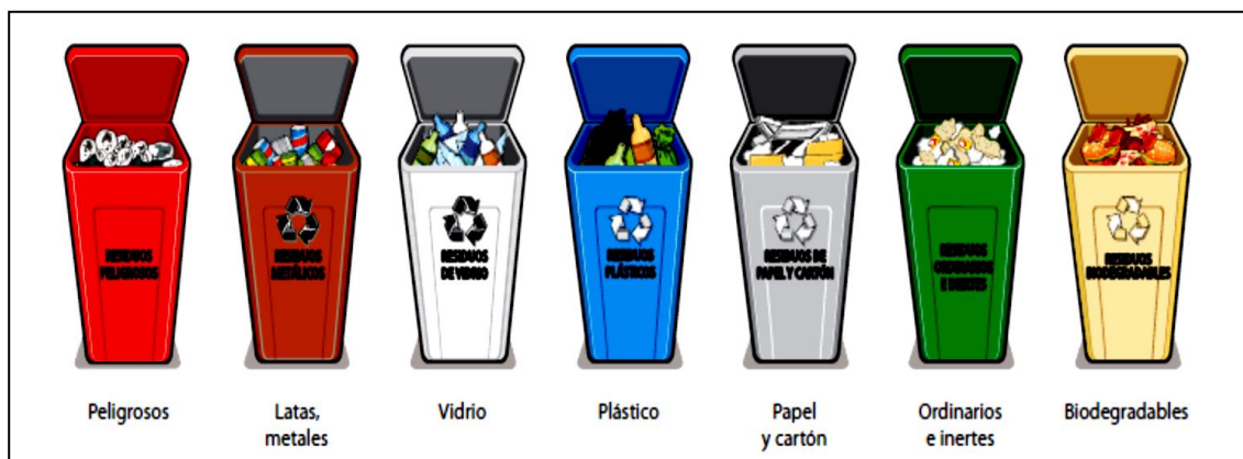
Figura 22. Recipientes utilizados para la separación de los residuos sólidos y su código de colores
