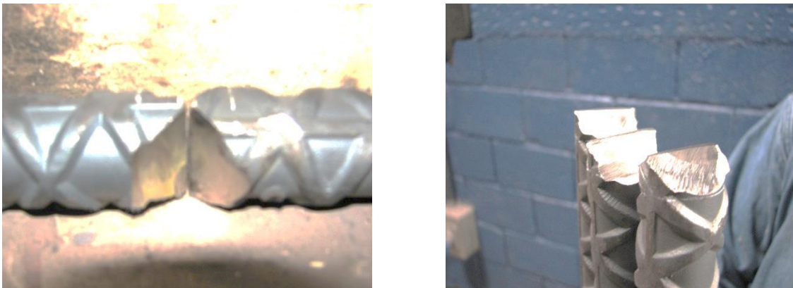
Figura 24. Bisel en X realizado a la barra A
