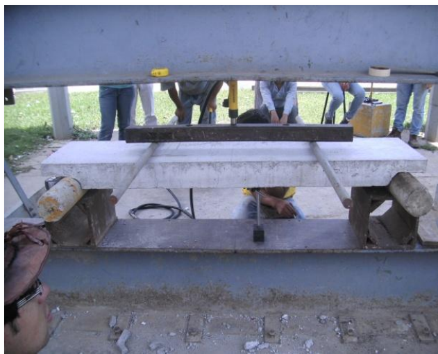
Figura 37. Ensayo de módulo de ferrocemento
