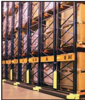
Figura 41. Arriostro en el sentido corto
