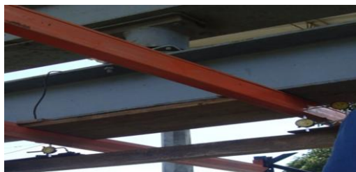
Figura 14. Aplicación de carga en los largueros
